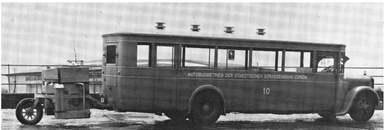
Autobus mit Holzvergaser-Anhänger. Holzgas-Generatoren für Lastwagen und Personenwagen wurden während des Zweiten Weltkriegs auch in Zürich Affoltern von der Firma HGZ an der Zehntenhausstrasse in grossen Serien hergestellt. Quelle: /14/
